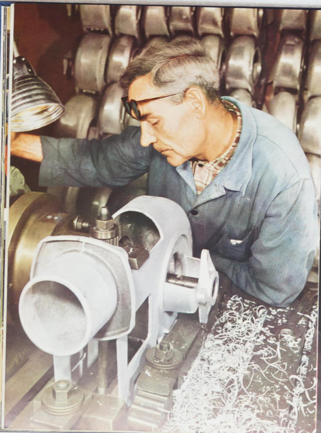
Bearbeitung eines Oelbrennergehäuses
