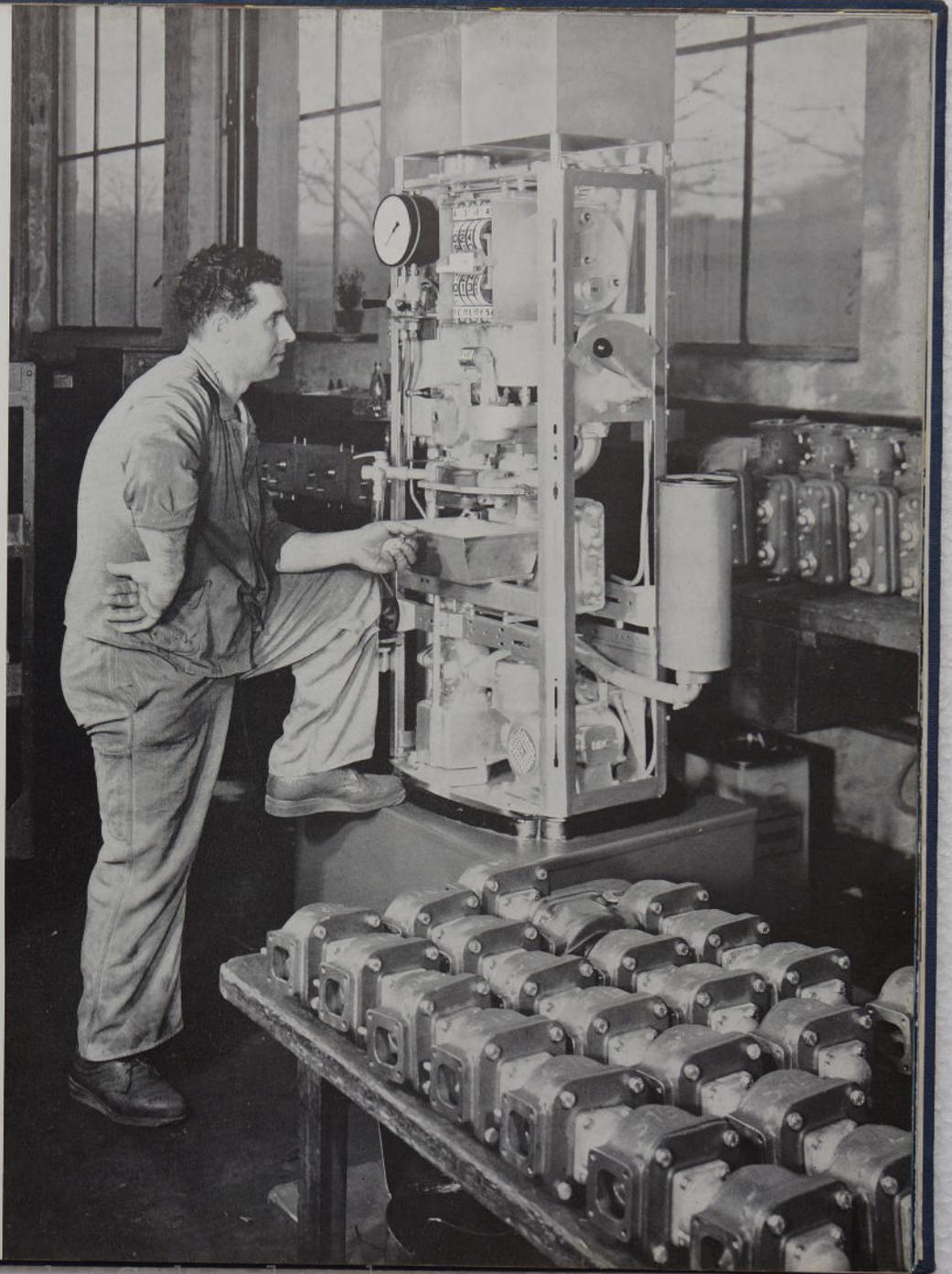
Prüfstand für Kolbenzähler
