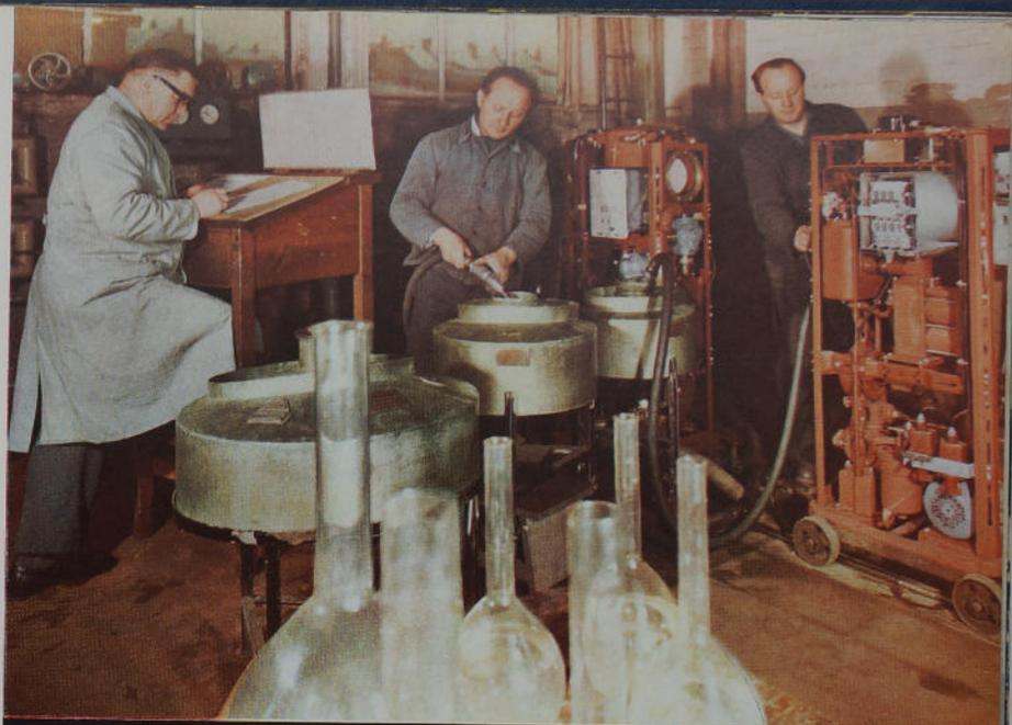
Schleifen spritzlackierter Zapfsäulen-Verkleidungen
