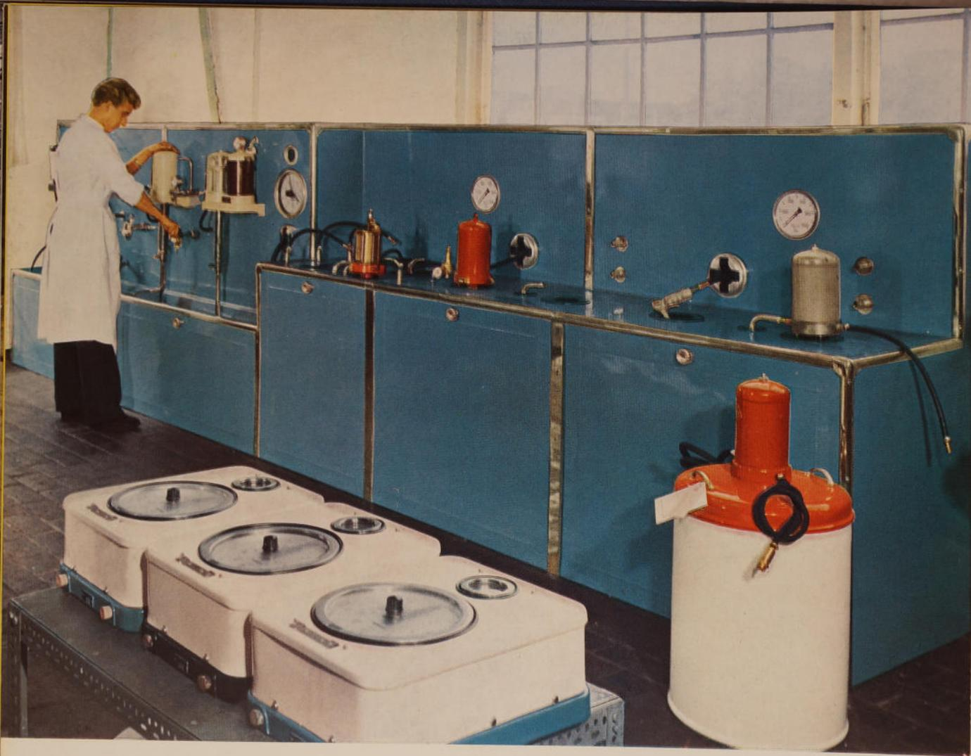
Prüfstand für Ölmeßgeräte und Hochdruckfettpressen
