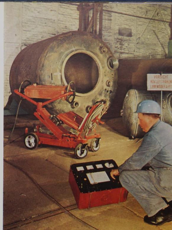
Röntgen-Untersuchung der Schweißnähte
