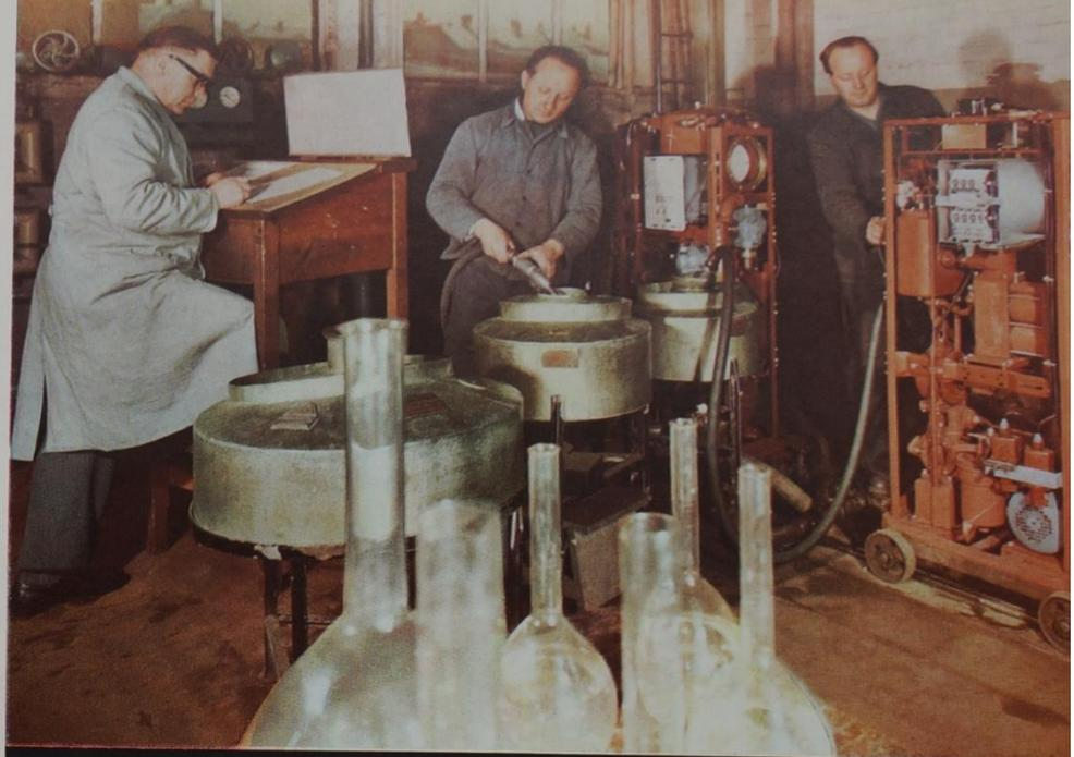
Schleifen spritzlackierter Zapfsäulen-Verkleidungen
