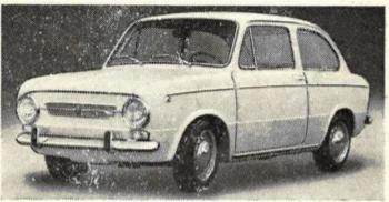
FIAT 850 "SPECIAL": 47 PS-vollsynchr. Viergenggetriebe (System Porsche) - Knüppelschaltung - Sportlenkrad - abbiendbarar Innenspiegel - Scheibenbremsen vorn - Schräglenkerachse hinten - Spitze 135 km/h - stehender km: 39 sec. - als Fünfsitzer zugelassen,
