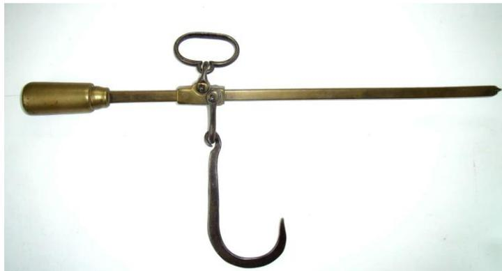
Laufgewichtswaage durchschiebbarer Skalenstange
