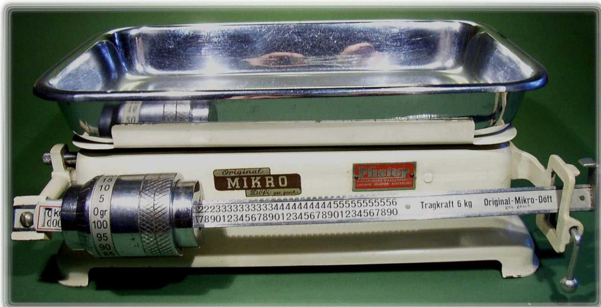
Laufgewichtsbrückenwaage als Haushaltswaage, um 1950
