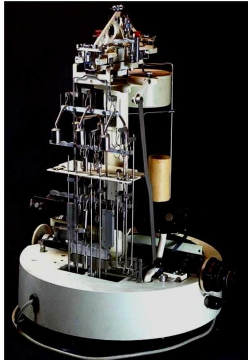
Substitutions-Analysenwaage von Fa. Sartorius, Göttingen. Das rechte Bild zeigt das Innenleben einer solchen Waage<sup>42</sup>.
