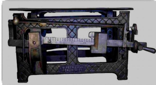
Links: Tischdezimalwaage mit einer Schale zur Aufnahme der Gewichte, rechts eine Brückenwaage mit einer Laufgewichtseinrichtung, Höchstlast: jeweils 25 kg
