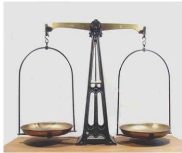
Etwas Erleichterung verschaffen starre Metallbügel statt Ketten oder Seilen. Dass hiermit jedoch die Maximalbelastbarkeit der Waage reduziert wird, ist der Preis für die Erleichterung
